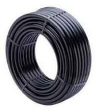
Esta tiene una presión y espesor de pared respectivamente de: 2.5bar, 1.2mm; 3bar, 1.4mm; 4bar, 1.7mm; 6bar, 2mm; 10bar, 3mm. Unas bobinas de 25m, 50m, 100m y 200m y el tamaño del tubo de polietileno son de 20mm y viene sin huecos y tercia en su totalidad. Fabricado en España.
