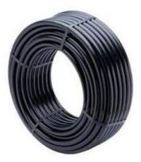
Esta tiene una presión y espesor de pared respectivamente de: 2.5bar, 1.6mm; 4bar, 2mm; 6bar, 2.3mm; 10bar, 3.5mm. Unas bobinas de 25m, 50m y 100m y el tamaño del tubo de polietileno es de 25mm y viene sin huecos y tercia en su totalidad. Fabricado en España.
